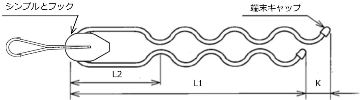
素線： JIS G 3506 (硬鋼線材)、亜鉛めっき
